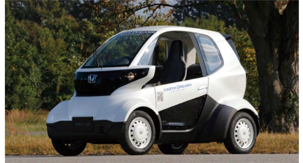
혼다의 2인승 소형전기자동차 MC-β 전장 2495x전폭 1280x전고 1545mm, 모터출력은 정격 6kW, 200V 3시간 충전으로 약 70km를 주행
