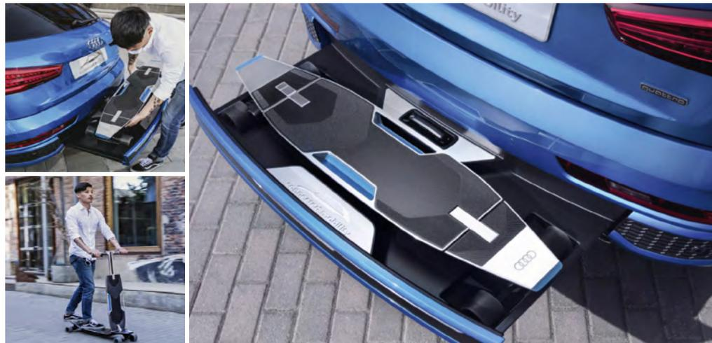
아우디의 SUV인 Q3 뒤쪽 범퍼 속에 전동 롱보드가 도킹되어 있음. 롱보드는 수납되어 있는 동안에는 내장 배터리를 충전함. Q3의 내비게이션 시스템은 운전자가 지정한 목적지를 인식한 후 실시간 교통 상황 데이터에 기반해 자동차로 이동하는 경로와 롱보드로 이동하는 경로를 혼합하여 가장 빠른 지점을 찾아줌. 전동 롱보드는 폴딩 디자인으로 스포츠형의 스케이트보드가 되거나 손잡이가 달린 킥보드가 됨. 수동으로 몰 수도 있지만, 최고 시속 18마일에 이르는 전기 모터를 사용해도 됨. 킥보드 상태에서는 사용자의 스마트폰을 핸들에 도킹해서 내비게이션으로 쓸 수 있으며, 짐이 있을 때는 롱보드 위에 수납한 후 자동으로 사용자를 뒤따라오게 만들 수도 있음.
