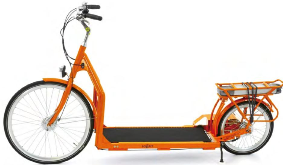
로피핏(lopifit.nl)의 창업자는 “자연을 즐기면서 트레드밀을 즐길 수 있을까?”라는 재미있는 생각을 가지고 새로운 자전거를 만들었음. 로피핏은 페달이 없는 대신 두 바퀴 사이에 트레드밀처럼 움직이는 발판이 있음. 사용자가 발판 위에 서서 런닝머신을 타듯 걸으면 자전거가 움직임. 작은 전동기가 내장되어 있어서 가볍게 걸으면서 시내를 달릴 수 있음. 개인 모빌리티가 점차 증가하는 지금, 로피핏은 독특한 설계와 디자인으로 새로운 방식의 이동 경험을 선사한다. 땅에 발을 구르거나, 페달을 힘차게 굴지 않고 자연스럽게 걷는 동작으로 자전거를 탐.
