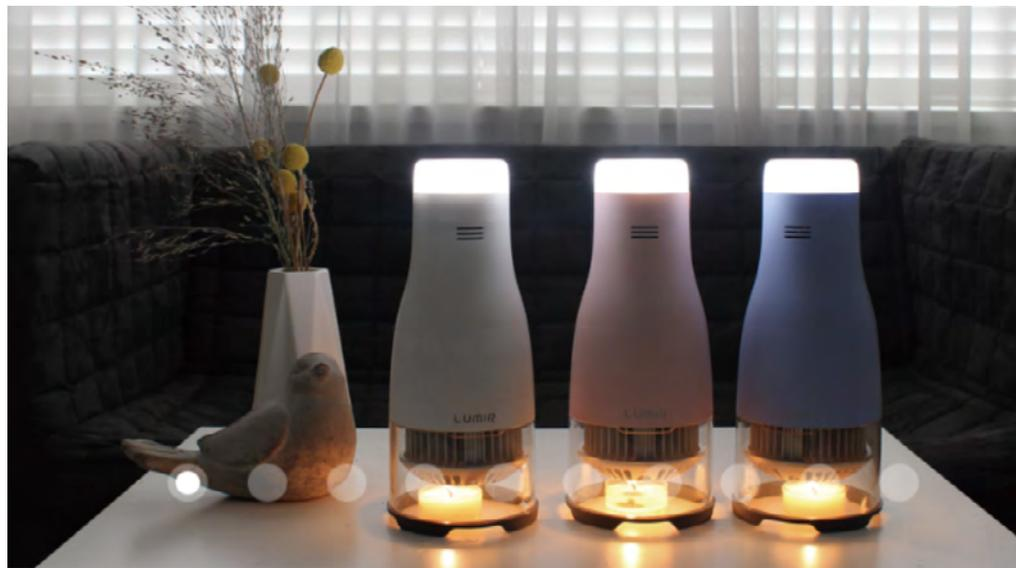
양초에 불을 붙인 후 그 양초 위에 루미르 C를 덮으면 발광되는 램프 제품이다. 성질이 다른 두 종류의 반도체에 온도차가 생길 때 전압이 발생하는 원리로 외부 전원이나 배터리 없이 촛불의 열에너지만을 통해 LED가 점등된다.
