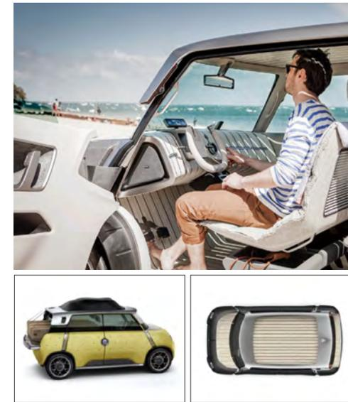
도요타의 전기자동차 '미위'는 외부적인 요소로부터 보호하기 위해 감쌌던 디자인과 다르게 자연환경과 소통하는 컨셉으로 자연 소재를 이용한 대나무 패널로 햇살이 스며들게 하였으며 앞쪽 창문에도 윈드 실드를 내려서 차 속으로 바람이 통과하며 외부 패널은 모두 폴리프로필렌으로 제작되었음.
