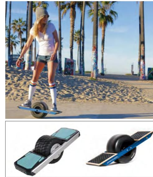
자이로 센서와 가속도 센서를 통해 사용자의 움직임에 따라 주행. 힘의 중심을 앞으로 두면 속도가 증가. 셀프 밸런스 기능으로 중심을 맞춰줌. 스마트폰 앱으로 연동돼 모드 변경, GPS를 이용한 주행 추적기 가능.
