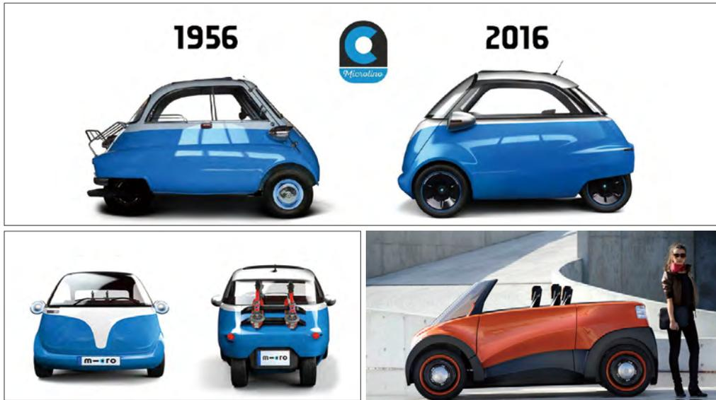
스위스의 워 아우보터는 마이크로리노(microlino.ch)라는 이름의 전기 자동차로 이세타를 부활시킴. 2016년 현재는 두 번째 프로토타입 단계이며 이세타의 귀여운 디자인을 조금 더 현대적으로 다듬어서 도심형 전기 자동차로 만들어냄. 마이크로리노는 길이가 2.4미터에 불과하며 무게는 400kg 안팎이라고 한다. 도어는 스티어링 휠과 함께 '앞쪽'으로 열리며 일반적인 주차 공간에 두 대의 마이크로리노를 세울 수 있음. 이세타의 매우 작은 몸 속에는 이제 싱글 실린더 엔진이 아니라 전기 모터와 배터리가 들어감. 매우 작은 크기에도 불구하고 2명이 탈 수 있으며 주차의 걱정 없이 그 어떤 좁은 골목에서 주행할 수 있음.
