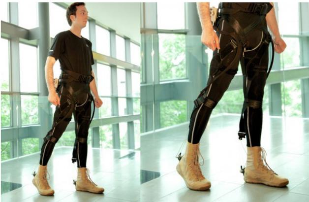
근 골격에 손상을 입은 군인을 위해 개발되었으나 일반인들도 사용할 수 있도록 제작된 웨어러블 로봇으로 신체의 움직임을 보완해줌. 군인들이 무거운 짐을 들고 전장에서 행군 또는 군수 물자를 조달 할 경우에 근육에 힘을 주지 않고도 무거운 물체를 손쉽게 들 수 있도록 도와주는 방식으로 새로운 기능성 텍스타일 기술이 사용되어 유용성이 높은 움직임을 지원해주는 파워 시스템과 부드러운 센서, 제어 기능이 장착되어 착용자의 힘과 움직임을 보완해 줌.
