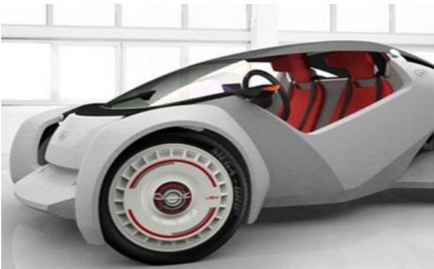
3D 프린팅으로 차체를 성형한 전기차 스트라티(Strati)는 미국 공작기계 업체인 신시내티(Cincinnati)사와 국립연구소인 ORNL(Oak Ridge National Laboratory) 등과 공동으로 개발 하였음. 차체 재료의 주성분은 ABS(acrylonitrile, butadiene, styrene) 수지. 여기에 강도를 높일 목적으로 13~20%의 탄소섬유를 혼합함. 2015년 4월 부터 주문을 받은 후 생산이 가능하며 대량생산이 아닌 개인 맞춤형 자동차를 가능하게 해줌.
