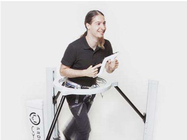
Virtualizer는 게임피트니스 기기로서 게임을 하며 직접 걷고 뛸 수 있게 함으로써 몰입감을 강화 시키는 장치로, 마치 유아용 보행기와 런닝머신을 연상하게 하는 형태로 되어 있음. 사용자가 안에 들어가 허리에 장치를 붙이기만 하면, 원형 기기 안에 있는 고감도 센서와 기동에 붙은 상하 가동 레일을 통해 게임 속에서의 모든 방향으로 실제로 똑같이 걷거나 뒷걸음 칠 수 있고, 뛰거나 점프, 앉거나 하는 등의 다양한 움직임을 인식할 수 있음. 특별히 전용 신발 같은 것은 필요 없으며, 양말을 신고도 플레이가 가능하여 층간 소음 등을 예방 할 수 있음.
