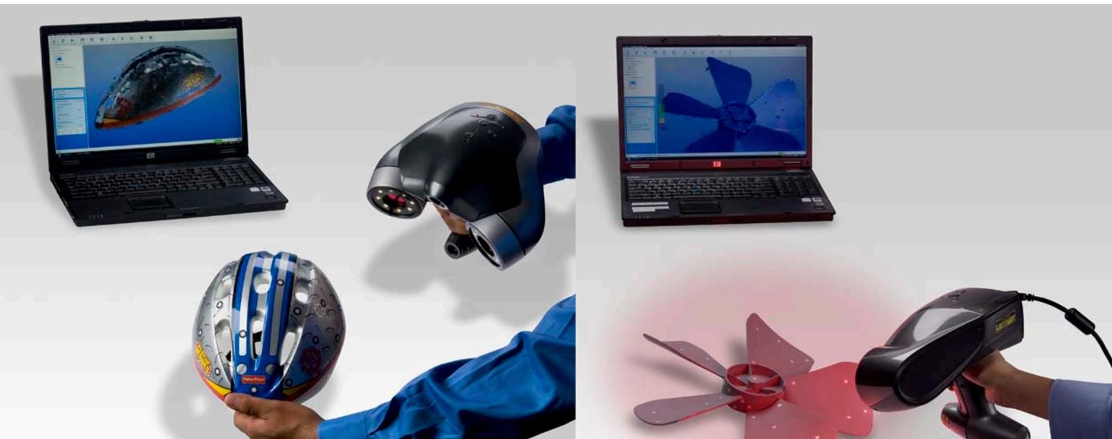
고, 어두운 표면에서는 적은 양의 빛만 반사한다. 유리나 같은 물체는 빛을 굴절시켜 잘못된 3D 정보를 만들어 내기도 한다. 대부분의 경우, 한 번의 스캔으로 물체를 완전한 모델로 만들 수는 없다. 하나의 물체를 모델링하기 위해서는 수백에서 수천 번에 이르는 다른 방향에서의 스캐닝 작업을 필요로 한다. 이렇게 스캔된 여러 장의 이미지들은 특정 부분의 데이터이기 때문에 하나의 좌표계로 합치는 작업을 해야 한다. 하나의 좌표계로 변환하는 작업을 정렬(Alignment) 또는 정합(registration)이라고 부르고 이렇게 정렬된 여러 데이터 셋을 하나의 데이터로 합치는 작업을 머징(Merging)이라고 부른다.
