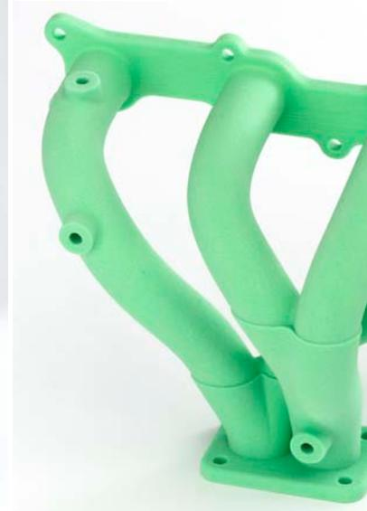
ber 와 같은 재료를 이용하여 마스터 패턴으로부터 마스터 다이를 제작하는 가공방식, 즉 마스터 패턴에 silicon rubber shell 를 입혀서 soft tooling 용 shell 로 이용하는 성형방식을 별도로 rubber-mold casting으로 지칭하기도 한다.
