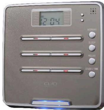
대우건설이 개발하고 대구 월드마크 웨스트엔드에 설치된 바이오 라이팅 시스템. 이는 우울증, 정서 불안 등 치료를 위해 조명을 이용하는 Lighting-Therapy를 주거 공간에 도입한 것으로, 실내 조명의 색과 조도를 변화시켜 거주자의 심리 상태와 바이오 리듬에 최적화된 실내 환경을 제공. 바이오 라이팅 시스템은 긴급 상황에 대비하여, 제어기 하부에는 LED 조명이 내장되어 화재나 지진 등으로 예기치 않은 정전이 발생할 경우 LED 조명이 자동으로 켜져 비상 유도등 역할 제공.
