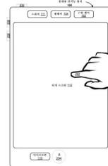
사용자가 터치스크린 디스플레이상에서 객체의 접촉을 통해 전자문서를 이동시키다가 전자문서의 가장자리에 도달할 경우, 해당 전자문서의 가장자리를 넘어선 영역이 디스플레이 외가 되다가, 사용자가 객체의 접촉을 중단하면 전자문서의 가장자리를 넘어선 영역이 디스플레이 되지 않을 때까지 해당 전자문서를 반대 방향으로 이동시키는 발명
