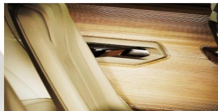
Lumine, Lamellux® 목재판 사이에 삽입된 광섬유를 통해서 빛이 투과된다.
