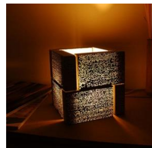
Litracon, Litracon 광섬유를 이용한 반투명한 콘크리트로 빛을 투과해 유리와 같은 느낌을 준다.
