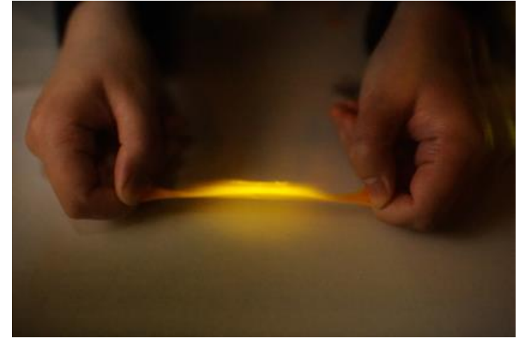
Light Emitting plastic, Technische Universiteit Eindhoven © Bart van Overbeeke 당길 때 빛을 방출하는 플라스틱. 내부 광원이 찢어지면서 빛을 낸다.
