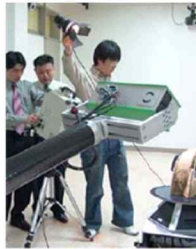
실제 발굴된 안학궁 치미와 찰흙으로 제작한 치미를 3차원 스캔 중인 사진 (tic.honam.ac.kr)
